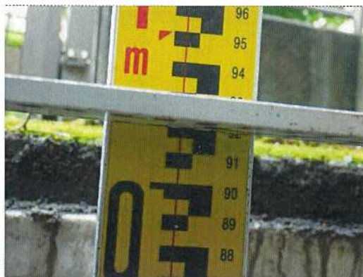
雨水桝-40 桝深さ測定近景
