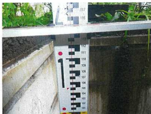
汚水桝-⑬ 桝深さ測定近景
