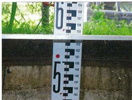
雨水桝-27 桝深さ測定近景
