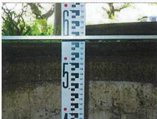
雨水桝-28 桝深さ測定近景
