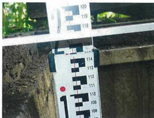
汚水枥-⑳ 枥深さ測定近景
