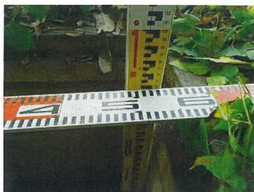
雨水桝-19 桝深さ測定近景
