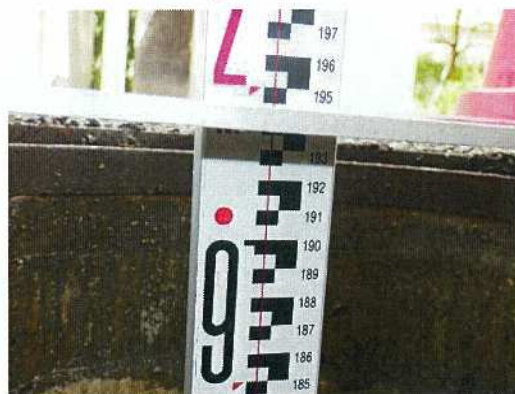
雨水桝-35 桝深さ測定近景
